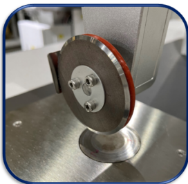
Anvil and Sonotrode
